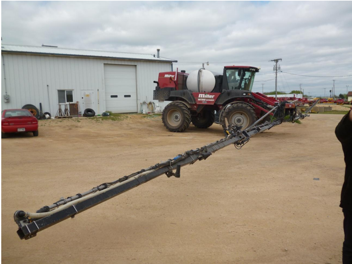
写真 6 ヴィータ・プラス社所有のスプレイヤー(幅 30m、GPS 付、200ha/日散布)
