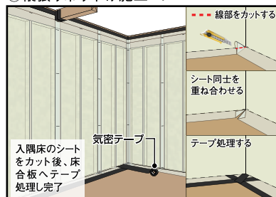
④縦張り吊り下げ施工-4
