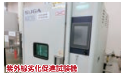
紫外線劣化促進試験機 30年相当の耐久性試験を実施
