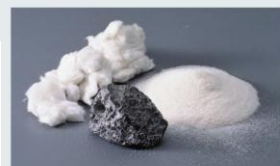
ダイライトの原料は火山性ガラス質材料と鉱物質繊維（ロックウール）
