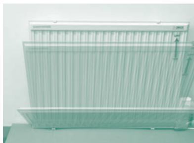
クリックが引っ掛かるまで、ブラケット上の上側のバネ付タブに垂直にヒーターを引っ掛けてください。ヒーターの幅は、冷たい下降気流を避けるために窓寸法に合わせましょう。
